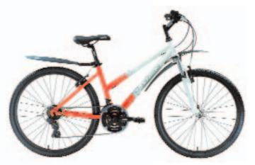
**Цепь:** KMC Z-50 **Каретка:** CH-48 loose balls **Система:** Prowheel 48/38/28
